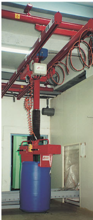
▲ 化學料桶運搬設備
