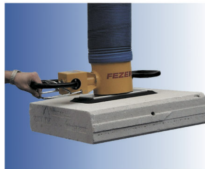
◀ 水泥預鑄 成品、石板 運搬
