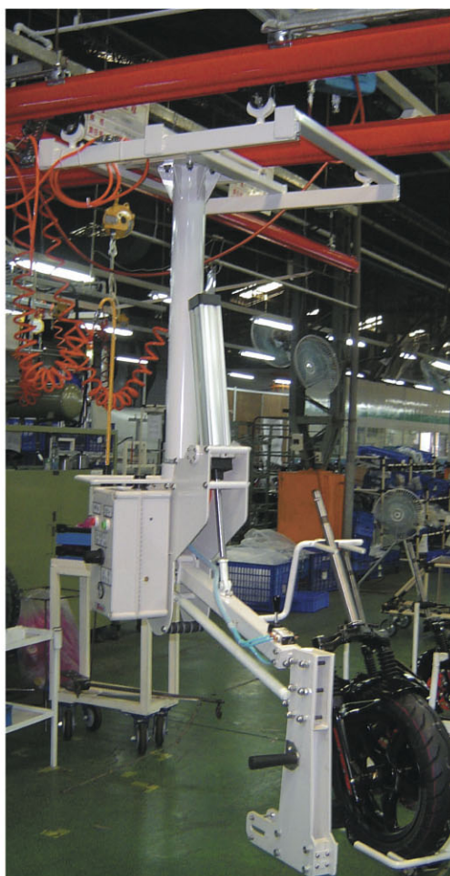
▲ 機車前叉組裝無重力平衡設備
